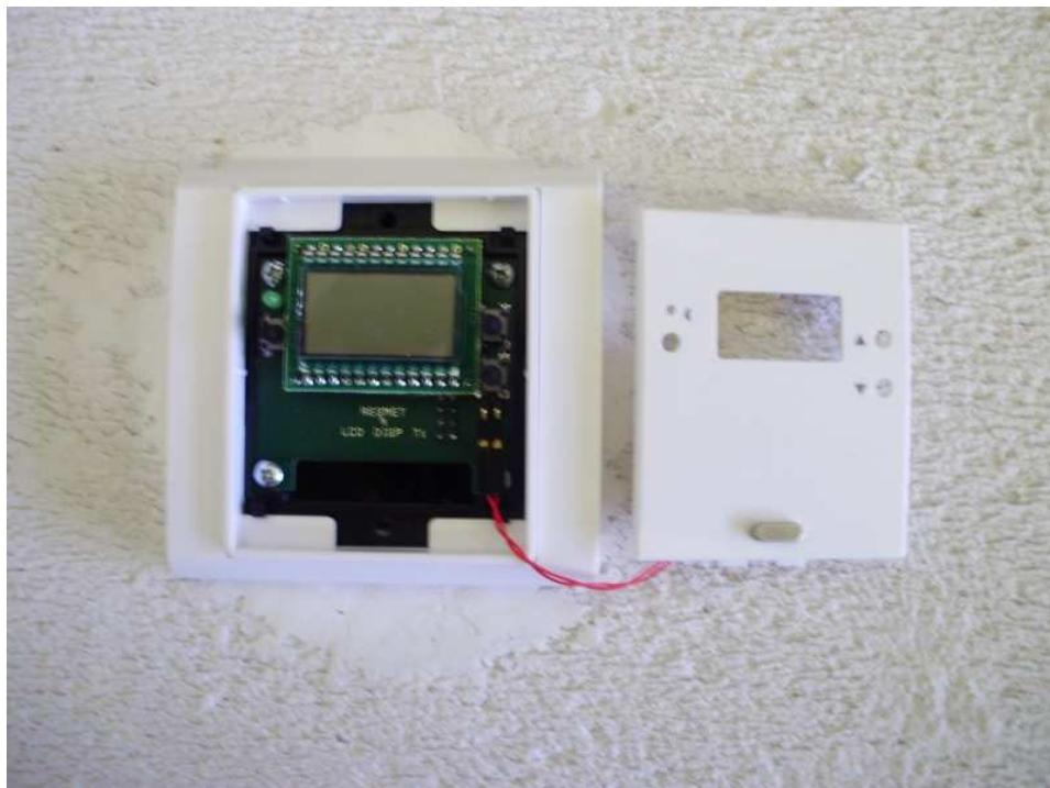
Kryt s čidlem teploty zacvakněte do mezirámečku. Při manipulaci dbejte na to, aby nedošlo k odpojení konektoru čidla teploty a aby tlačítka procházela skrz kryt.
